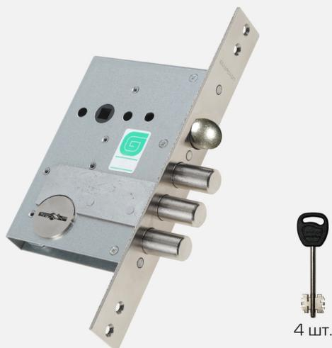
Предназначен для установки в металлические двери, шкафы и сейфы (как правого, так и левого открывания). Переворот защелки выполняется без разборки замка. Бронепластина надежно защищает от высверливания. Дополнительно защищен от самоимпрессии (патент на ПМ № 100538), декодирования (патент на ПМ № 102224). Устанавливается с ручками: "Гардиан 41.31", "Белла", с разделной фурнитурой.
