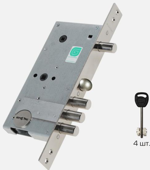
Предназначен для установки в металлические двери (как правого, так и левого открывания). Устанавливается с отдельной фурнитурой. Переворот защелки выполняется без разборки замка. Бронепластина надежно защищает от высверливания. Дополнительно защищен от самоимпрессии (патент на ПМ № 100538), декодирования (патент на ПМ № 102224).
