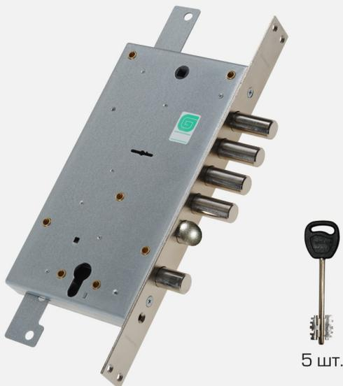
Предназначен для установки в металлические двери, шкафы и сейфы (подходит как для дверей правого, так и левого открывания). Переворот защелки выполняется без разборки замка. Может устанавливаться с вертикальным приводом для запираения двери на три стороны. Возможна комплектация без торцевой планки. Рекомендована комплектация броненакладкой и бронепластиной.
