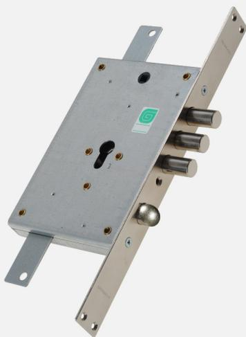
Предназначен для установки в металлические двери, шкафы и сейфы (подходит как для дверей правого, так и левого открывания). Переворот защелки выполняется без разборки замка. Может устанавливаться с вертикальным приводом для запираения двери на три стороны. Возможна комплектация без торцевой планки. Рекомендована комплектация броненакладкой.
