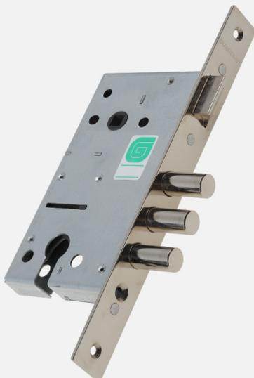
Предназначен для установки в металлические и деревянные двери, металлические шкафы и сейфы (подходит как для дверей правого, так и левого открывания). Переворот защелки выполняется без разборки замка. Устанавливается с ручками "Гардиан 41.32", "Гретта", "Диана", с ручками на планке (межосевое расстояние 85 мм) или с отдельной фурнитурой. Возможна установка броненакладки.
