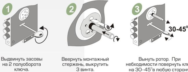
Установка кодового ротора
